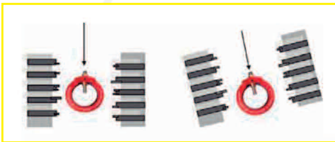
Colocación en el casquillo. El eje vertical de la sonda debe colocarse en el mismo plano que el eje vertical de desplazamiento de los carros.
