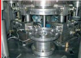
**Bordonado** de elementos de protección del tambor de lavadoras en acero de alta calidad. Cuatro boquillas lubrican los rodillos de conformado y los protegen del sobrecalentamiento y del desgaste.
