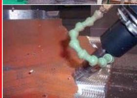
**Fresado** de prototipos y muestras de acero endurecido. Hasta el momento, la lubricación se realizaba empleando un aerosol manual, con el que se empleaba lubricante en exceso, contaminando la herramienta, las virutas y el entorno. Con el sistema MQL no solo el entorno de la máquina se vuelve más limpio y las virutas se mantienen secas, sino que, además, la calidad de las superficies procesadas mejora decididamente.
