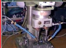
**Roscado por laminación** en fundición de zinc con un taladro Maxion en la empresa de un subcontratista. Hasta el momento, la lubricación se realiza empleando una brocha, resultando en una escasez o exceso de cantidad de aceite. Mediante la adaptación de un sistema de MQL sin aire la productividad se aumenta en un 10% y la vida de las herramientas en un 30%.
