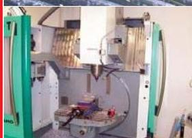
**Fresado** de piezas individuales de diversos tipos de materiales en una DMG 50T del taller mecánico de un instituto. En comparación con el procesado en seco empleado anteriormente, la vida útil de las herramientas se ve completamente mejorada.
