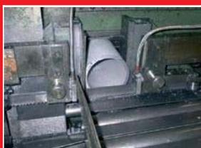
**Serrado con cinta** de tubos de aluminio. Dos bloques-boquilla proporcionan lubricación tanto antes como después del corte del tubo. Cuando se empleaba refrigeración por inundación, la emulsión empapaba los tubos, que tenían que ser secados, comportando más complejidad a las condiciones de trabajo
