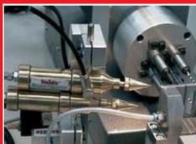
**Roscado M4 x 9** en fundición de zinc con taladrado previo de los agujeros previos de fundición. Una única gota de lubricante es disparada con alto grado de precisión sobre la herramienta, de manera previa a su utilización. Son suficientes 20 litros de lubricante MQL para la producción anual de 1,2 millones de roscas.
