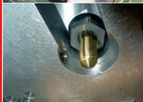
**Roscado por laminación** de dos roscas internas con un macho de laminación M10 recubierto en TIN en productos sanitarios hechos de plancha de acero galvanizada. La necesidad de evitar la refrigeración por inundación provocó que se probara el procesado en seco, con lo que la herramienta solo pudo realizar 200 roscas, aproximadamente. Con el MQL Steidle, se aumenta esta cifra hasta 7000 roscas.
