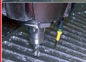
**Fresado** de muestras de galgas de plástico o aluminio en una fresadora de pórtico Zimmermann FZ 40 de 5 ejes. En este proceso, la mezcla de aceite y aire es conducida a través de un conducto lateral de refrigeración del cabezal y se pulveriza mediante un tubo de boquillas multi-conexión empleando un sistema de MQL de alimentación interior. Además, en caso necesario, las virutas pueden ser eliminadas del espacio de trabajo mediante la función de spray de aire.
