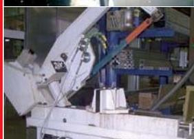
**Serrado** en un taller. La sierra Kasto HBS1 empleaba un sistema de refrigeración por inundación. Sin embargo, puesto que esta unidad no se emplea de forma regular, la emulsión siempre se corrompía durante los meses calurosos del año. Con el sistema MQL instalado este problema desaparece totalmente.
