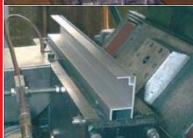
**Roscado por laminación M5 x 5** de secciones de aluminio para plantas de ingeniería. Primero se realiza el taladrado previo de todos los agujeros roscados. El macho de laminación se lubrica brevemente mediante la pulverización con una boquilla justo antes de su utilización. Se obtiene una reducción drástica de la cantidad de lubricante requerida comparado con los sistemas de goteo previamente utilizados.
