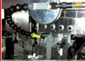
**Forjado** de anclajes de soporte fabricados en acero zincado junto con una banda de acero blanco. Al realizar el forjado se producen pequeños trozos de residuos que pueden ser arrastrados por el útil. Se aplica un recubrimiento fino anti-adhesión mediante un sistema MQL.
