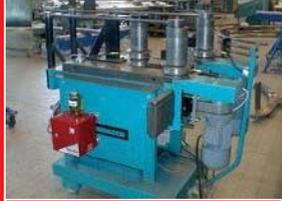
**Doblado** de tuberías de cobre. El spray se aplica a los rodillos durante el proceso de doblado. De esta forma, el cobre ya no se adhiere a los rodillos y no se han de realizar segundas operaciones en los productos acabados.
