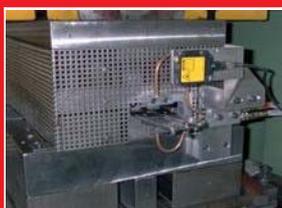
**Forjado** de bielas. El spray se aplica en las partes superior e inferior. En comparación con la lubricación manual, método empleado anteriormente, ahora la aplicación del lubricante es mucho más uniforme y el útil tiene mayor vida.
