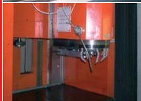
**Fresado** de piezas de plástico en un centro de mecanizado. Debido a que la emulsión ataca el plástico, hasta la introducción de la solución MQL el proceso se realiza en seco. Esto implicaba que la calidad superficial de las piezas fuese insatisfactoria. Ahora el proceso de fresado se lubrica empleando una boquilla. Esto mejora la calidad superficial, e incluso a permitido efectuar un acabado espejo en algunos tipos de plástico.
