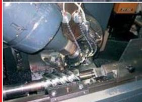
**Fresado** de un rotor de compresor hecho en acero aleado con una fresa de  $\varnothing 250$  mm. En comparación con el mecanizado en seco, el uso de MQL provoca un incremento de la vida del filo de corte, mejora el acabado de las superficies y reduce la temperatura en la pieza.
