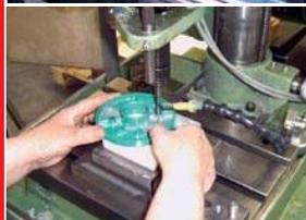
**Roscado M8** en fundición y acero inoxidable para la fabricación de sistemas de cierre de puertas. Hasta el momento, el aceite se aplicaba mediante una brocha. Puesto que este proceso requería muchos esfuerzos y costes y no era uniforme, se buscaron alternativas. Gracias al sistema sin neblina de MQL, ahora la lubricación es segura, se reduce el tiempo y se elimina el proceso de desecho del aceite.
