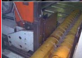
**Serrado con cinta** para un negocio relacionado con acero realizado en un equipo de serrado Kasto twinA4. Aquí surgen problemas de vida útil con el antiguo sistema de pulverizado al serrar materiales de diámetro 100 mm por parejas, ya que este no producía el volumen requerido. Con el sistema Steidle, ahora se sierran las barras sin errores y con una vida útil adecuada.
