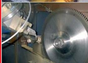
**Tronzado circular** para series de fabricación de grifería sanitaria. Las rebabas del moldeado se separan mediante el equipo de serrado. Se descarta totalmente la refrigeración por inundación, por no ser interesante ya que no es adecuado tener ningún tipo de residuo durante el refundido. Se realiza un test comparativo entre el procesado en seco y con MQL. La prolongación de la vida útil logra amortizar el sistema MQL en solo 13 días.
