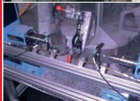
**Roscado** en fundición de zinc para la industria del automóvil. Al contrario que con el sistema básico de MQL empleado hasta el momento, con un producto diseñado por Steidle se consigue dosificar una cantidad considerablemente más exacta y evitar la nebulosidad del medio.
