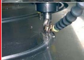
**Fresado** de ranuras en forma de T circulares en planchas (hasta  $\varnothing 3000$  mm) de St52. Debido al tamaño de las piezas y la concepción abierta de la máquina, el uso de refrigeración por inundación con emulsión no era posible. Se opta por lubricar las fresas mediante 2 boquillas. Se obtiene un incremento del 100% de la vida del filo de corte en comparación con el proceso en seco.
