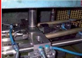
**Repulsado** de tapas de cierre de acero inoxidable, que hasta el momento se lubricaba mediante un cierto tipo de sistema de goteo. La cantidad aplicada era tan grande que las piezas tenían que ser colocadas en depósitos de secado y, posteriormente, limpiadas. Con el sistema MQL actual, el consumo se reduce de 10 a 3 litros de aceite por turno. Además, la vida del baño de limpiado ha aumentado ya que, ahora, la inyección de aceite es menor.
