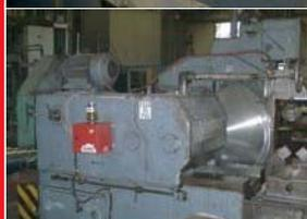
**Tronzado circular** de rodillos de acero Ø400 mm. Debido a que la sierra se utiliza con poca frecuencia, los costes de mantenimiento y eliminación de la emulsión superaban con mucho la productividad de la sierra. El paso a MQL permite que no se necesite el uso de emulsión
