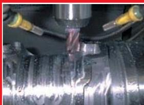
**Fresado** en acero templado de herramientas (60 HRC) para fabricación de moldes con un tiempo de proceso de 3 horas por pieza. En el mecanizado en seco, la vida del filo de la herramienta no alcanza a mecanizar 1 pieza. 2 boquillas MQL lubrican las fresas y doblan la vida del filo de las herramientas. De este modo, se elimina el cambio de herramienta durante el proceso.
