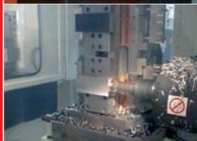
**Fresado y taladrado** de aluminio en un centro de mecanizado. MQL con lubricación interna empleando cabezal y máquina de refrigeración interna.
