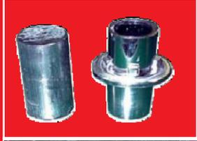
**Conformado** de piezas en bruto de plomo (Ø15 mm, altura 40 mm) para la fabricación de componentes de la industria del automóvil en un único ciclo de operación. Una gota de aceite de conformado se aplica en cada bruto previamente al ciclo de operación.
