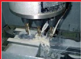
**Taladrado** de tubos de acero rectangulares. La refrigeración por inundación se usó anteriormente. El cambio a MQL consigue una reducción de la polución y mejora de la seguridad del lugar de trabajo. Además, la vida útil de las herramientas se triplica.
