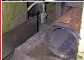
**Serrado con cinta** de tuberías de acero para sistemas de taladrado para la construcción de pozos profundos y calles. A lo largo de las tuberías, siempre se conseguía una descarga considerable de emulsión alrededor de la máquina. Gracias al uso del sistema MQL, se consigue “secar” la periferia de la máquina.
