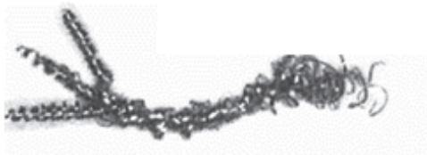
Virutas con PO-VA a 4 m/min
